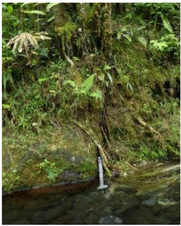
Photographie 4. Sonde limnimétrique connectée à un enregistreur
